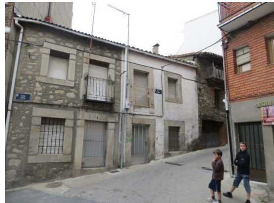
Los huecos se recercan con piedras escuadradas, como también las esquinas. Aparecen balcones de forja y carpinterías con cuarterones.
